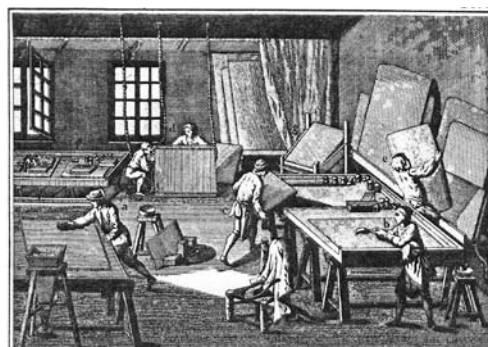
図11：十八世紀ヨーロッパの鏡製造工房（部分） （『フランス百科全書絵引』平凡社刊、1985より） スズ箔に水銀を塗布して銀メッキをする工程。
