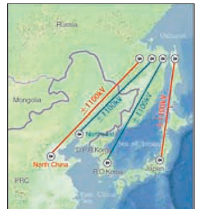
図6 サハリン北部風力発電によるアジア諸国への電力輸出ルート案
