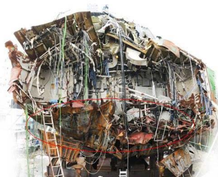
天安艦の破損状態
