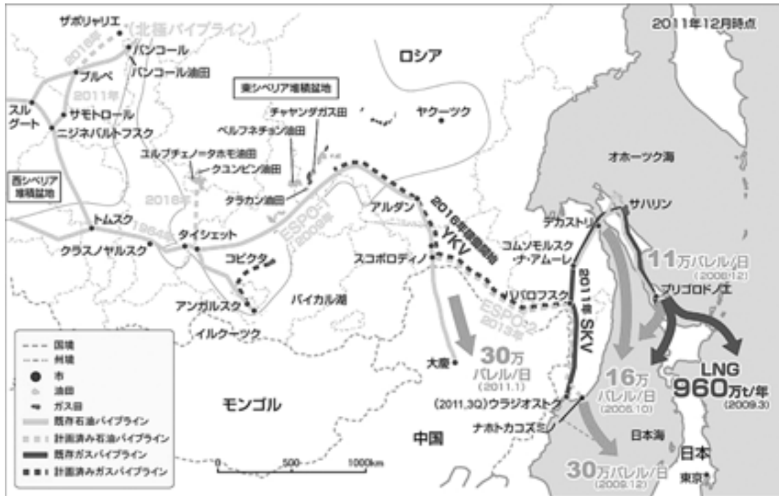
西シベリア北東部からの「北極パイプライン」と、東シベリアからの「ESPO」と「YKV」パイプライン、サハリンからの「SKV」パイプラインと新規石油、ガスのソースを示す (JOGMEC作成)
