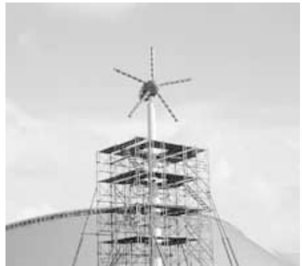
図4．新型マグナス風車 写真提供：秋田マグナス協会 本部事務局
