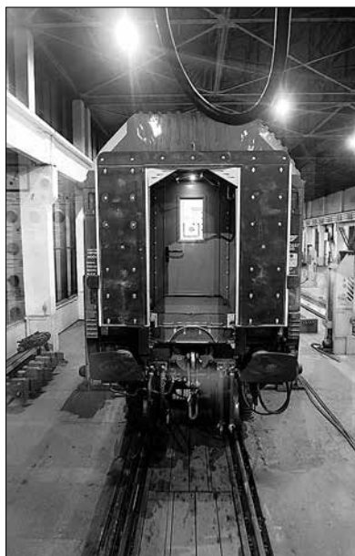
写真1 プレスト駅での軌間変更の様子
