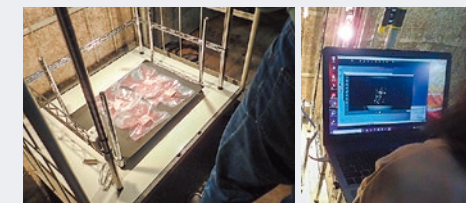
雪室内の牛肉・豚肉をハイパースペクトルカメラ(HSC)で撮影する
